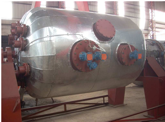
为适应高纯石英砂提纯工艺要求研发制造出的旋转式衬四氟反应釜
