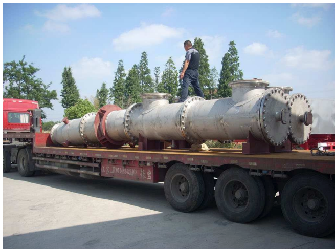
金梯四氟制造的钢衬四氟反应塔，正装车发往内蒙恒业成有机硅公司
